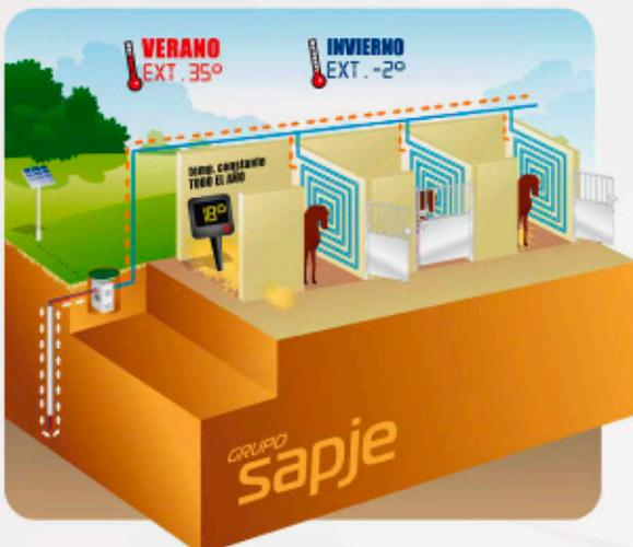
Este sistema consiste en la captación de energía que disponemos en el subsuelo durante todo el año. Esta energía es aprovechada y trasladada a paneles radiantes que disipan esa energía en forma de calor en invierno y en forma de frío en verano.
